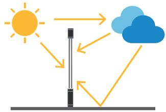
Die im Glas eingekapselten Solarzellen produzieren Strom aus Sonneneinstrahlung von beiden Seiten (bifazial).
